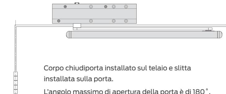
Corpo chiudiporta installato sul telaio e slitta installata sulla porta.
