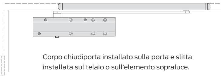
Corpo chiudiporta installato sulla porta e slitta installata sul telaio o sull'elemento sopra luce.
