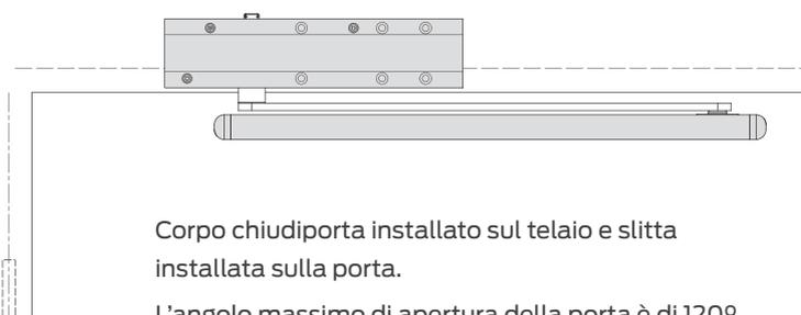
Corpo chiudiporta installato sul telaio e slitta installata sulla porta.
