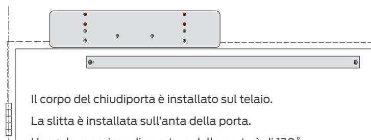
Il corpo del chiudiporta è installato sul telaio.
